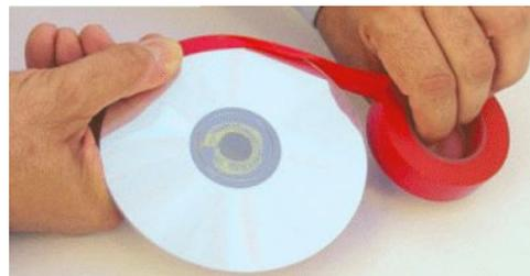
(Figure 3.2.10 Mise en place d'une couche d'isolant autour du CD pour augmenter l'adhérence)
